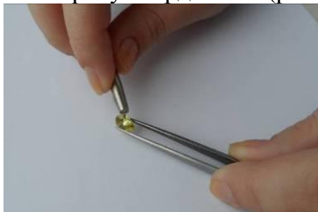
Рисунок 3 – Визначення твердості об'єкта дослідження
